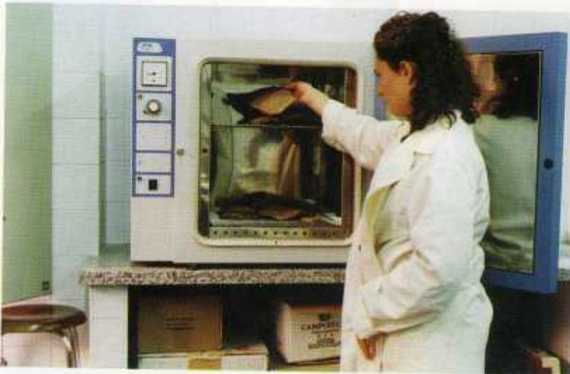
Foto n.º 4 - Secado de fragmentos en estufa de aire. Una vez llevados a cabo los procesos húmedos de tratamiento, los fragmentos son colocados en una estufa de desecación, lo que acelera en gran medida el secado y permite continuar con el resto de tratamientos.
