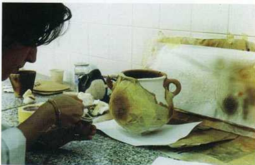
Foto n.º 12 - Reintegración cromática de 119617A por medio de aerografiado con tintas al agua.
